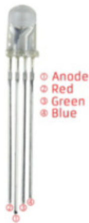
Correspondance des différentes pattes d'une LED RGB
